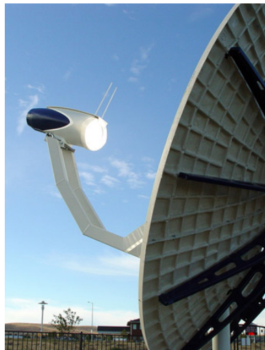
【Dish type solar thermal generator】
