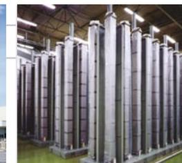
加圧水型原子炉燃料(燃料集合体) 長さ約4メートル
