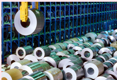
鉄鋼メーカーが製造する鋼帯を加工するコイルセンター
