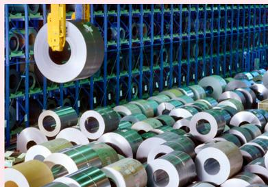
鉄鋼メーカーが製造する鋼帯を加工するコイルセンター
