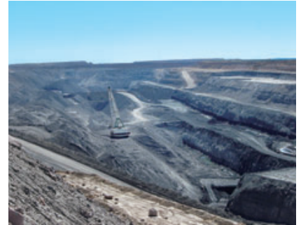
BMA炭鉱におけるドラッグラインによる剥土作業。
